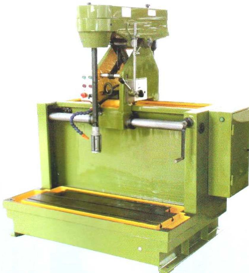
**CARACTERISTICAS:** La bruñidora 3M9814A es empleada para el bruñido de cilindros de autos y camiones con cilindros de diámetro 40 a 140 mm. El cabezal de la máquina se desplaza de forma longitudinal facilitando la operación. El recorrido del bruñidor hacia abajo y arriba es accionado de forma hidráulica.
